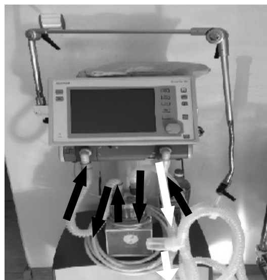
写真3 人工呼吸器の誤った接続
